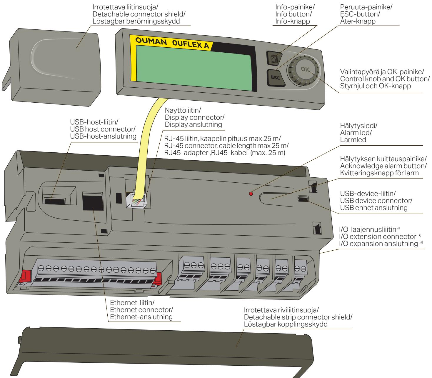
\* I/O-laajennusmodulit voidaan kytkää emolaitteeseen OUFLEX EXUn avulla, joka muuntaa RJ45 liittimen ruuviriviliittimeksi.
