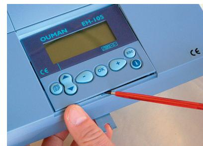
Осторожно, с помощью отвёртки, отделяйте узел клавиатуры/экрана.
