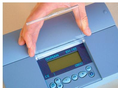
Удалите прозрачную крышку. Надавите, как показано на рисунке, и снимите крышку.
