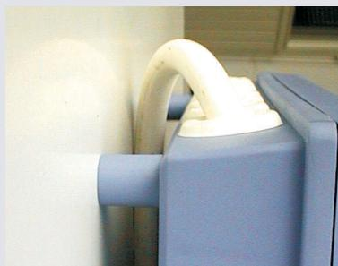
Кабель, при необходимости, можно провести между регулятором и монтажным основанием, если для крепления регулятора использовать распорные втулки.
