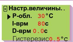
В регуляторе ЕН-105 на выходе, предназначенном для нагрева, используется PID-управление. Если используется электрорадиатор, необходимо настроить также и величину гистерезиса.
