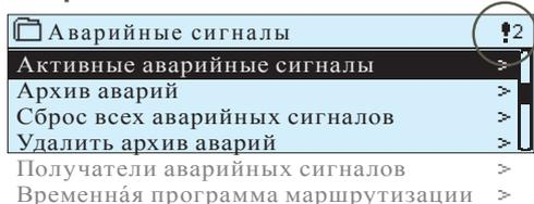
В меню аварийных сигналов устройства С203 пользователь может просмотреть активные в текущий момент времени аварийные сигналы, а также аварийные сигналы, возникшие в устройстве ранее. При наличии в устройстве активных аварийных сигналов их количество отображается в правом верхнем углу основного режима дисплея.
