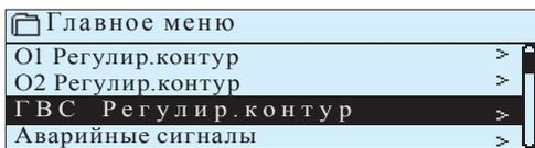
Устройство С203 обеспечивает поддержание температуры воды в сети ГВС на отметке уставочного значения. В связи с опасностью образования бактерий не рекомендуется понижать температуру воды в сети ГВС ниже отметки 55°C на длительное время.
