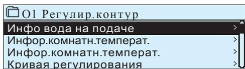
Терморегулятор S203 позволяет обеспечивать управление двумя отдельными регулировочными контурами подающей воды независимо друг от друга (контур O1 и O2).
