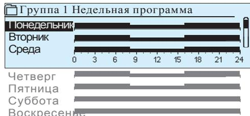
Данный пример показывает, что аварийные сигналы аварийной группы 1 всегда передаются следующему получателю. Аварийные сигналы передаются в рабочее время (пн-пт с 8 до 16 ч) одной бригаде, а в нерабочее время и на выходных – другой бригаде. Более подробная информация представлена в окне корректировки.
