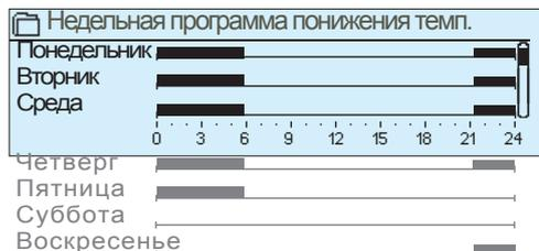
В составе недельных программ используются графические изображения в режиме общего вида и в режиме корректировки, содержащие данные о точном времени поступления новой команды управления. В графическом окне данные о понижении температуры в случае их отклонения от заданного температурного режима отображаются в виде балки.
